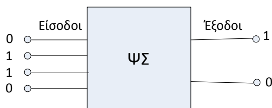
Σχήμα 1.1 Ψηφιακό κύκλωμα με 4 εισόδους και 2 εξόδους
