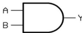
Σχήμα 1.4: Πίνακας αληθείας και κυκλωματικό σύμβολο πύλης AND
